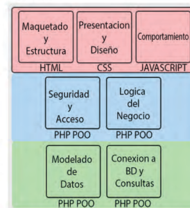
Figura 4. Arquitectura N-capas empleado en los proyectos de la UTT
